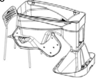
Encaixe o conjunto assento (C) na base do lavatório (B) na correta posição de montagem.
