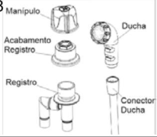
Montagem registro plástico uma entrada: Monte o conjunto registro (G) e ducha (G) na cuba (A), remova o manípulo encaixado e o acabamento do registro rosqueado. Após encaixe o registro na parte inferior da cuba e rosqueie o acabamento do registro na parte superior da cuba dando o aperto necessário. Encaixe novamente o manípulo manualmente. Rosqueie a ducha no conector.
