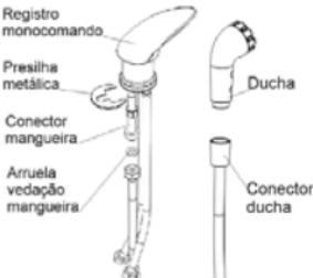
10 Instale as mangueiras (G) conectando ao registro (G) nas opções conforme as imagens e de acordo com a necessidade.
