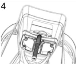
Fixe os 6 parafusos M5 x 20 (F) que unem o conjunto da cuba (A) com a base (B) utilizando chave philips comum (acesso pela parte inferior da base).
