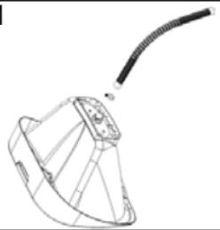
Apoie a cuba (A) no chão, virada para baixo com alguma proteção para não riscar, encixe a mangueira de saída d'água (E) na cuba (A) e aperte a abraçadeira MINOR (I) utilizando uma chave de fenda comum.
